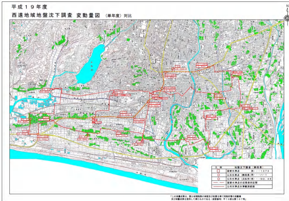
図 5-11 地盤沈下調査変動量図 西遠地域 (静岡県くらし・環境部環境局水利用課, 2007)
