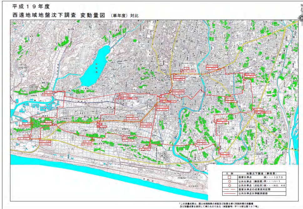
図5-27 地盤沈下調査変動量図 西遠地域
