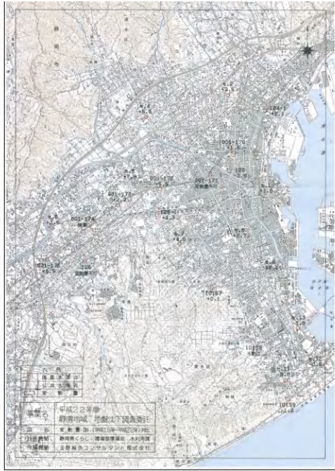
図 5-21 地盤沈下変動量図 静岡地域
