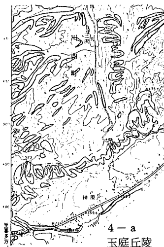
図4 なるべく小さな図示単位で表記した傾斜 30^\circ の界線の例（縮尺 1/50,000 ）
