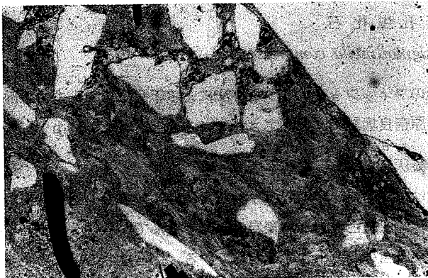
写真7：才津累層の溶結凝灰岩の顕微鏡写真 (40×, -ニコル)
