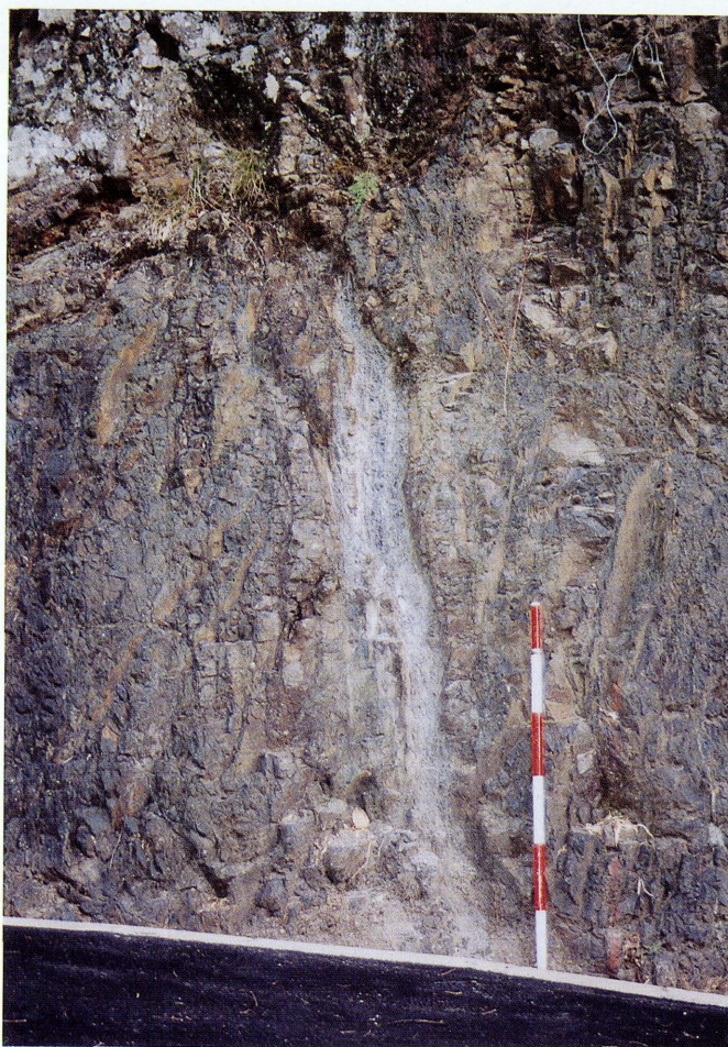
② 地吉大畑、林道ヤイケ線終点。泥岩勝ち砂岩泥岩互層で黒～黒灰色を呈し砂岩は引きちぎれた状態で、泥岩は小岩片状に崩れ易い。
