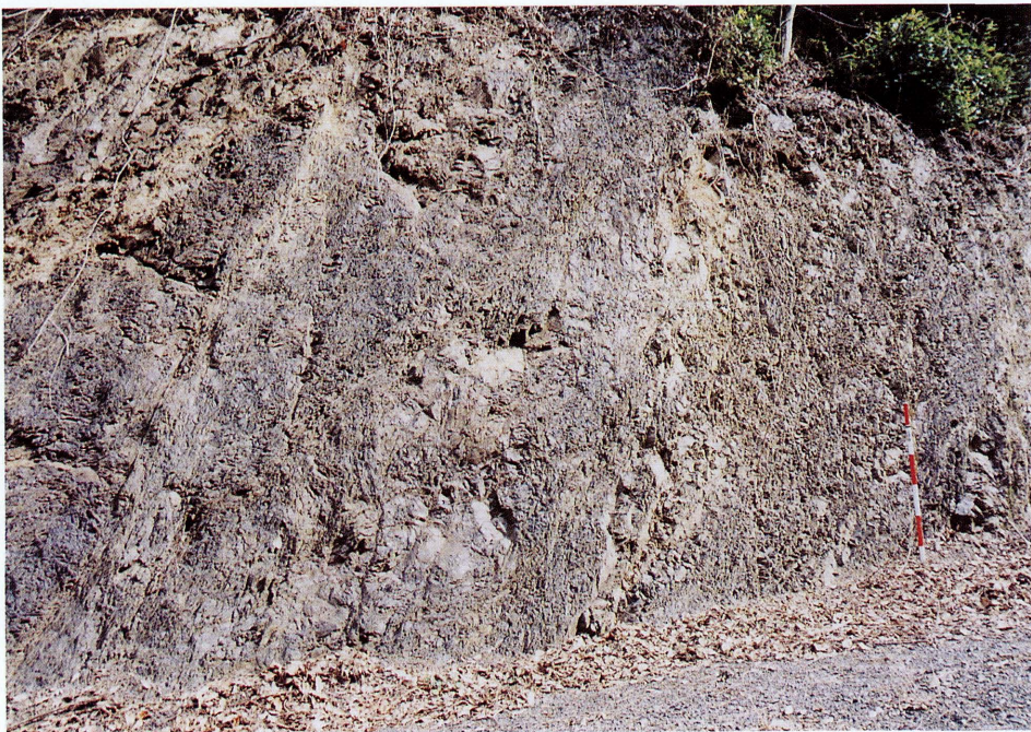
⑩ 大井川八木線最奥の泥岩勝ち砂岩泥岩互層。黒灰色を呈しせん断を受け、細片状に剝離し易い。
