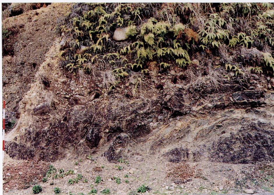
⑫ 大井川駄馬の頁岩。黒～黒灰色を呈し、細片状の剝離し易いもの、硬岩で塊状のものがある。
