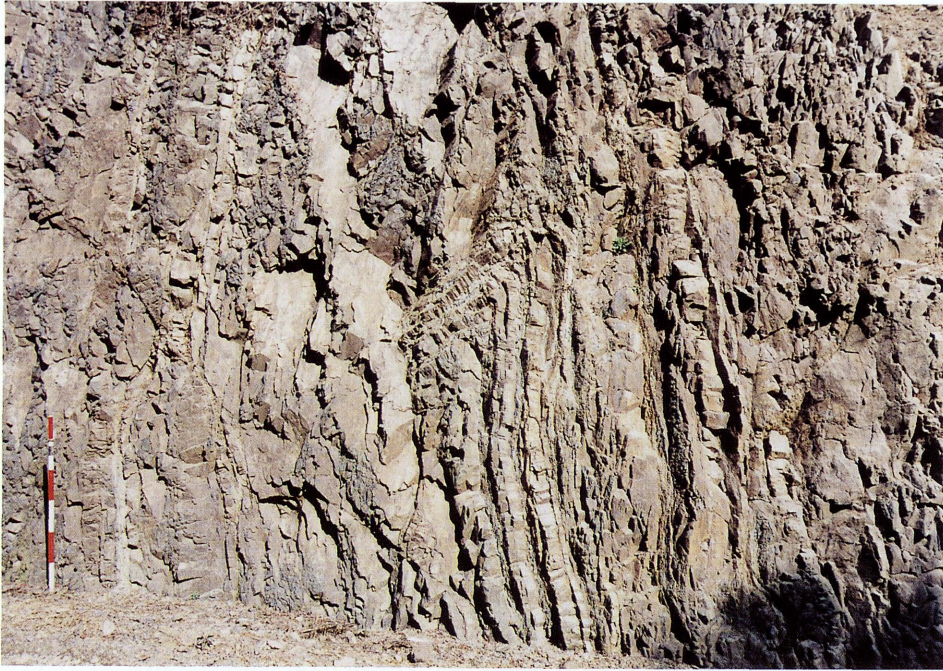
⑤ 十川白井川上流、梶ヶ谷最奥の泥岩勝ち砂岩泥岩互層。黒灰色を呈し、小ブロック・岩片状に崩れ易い。
