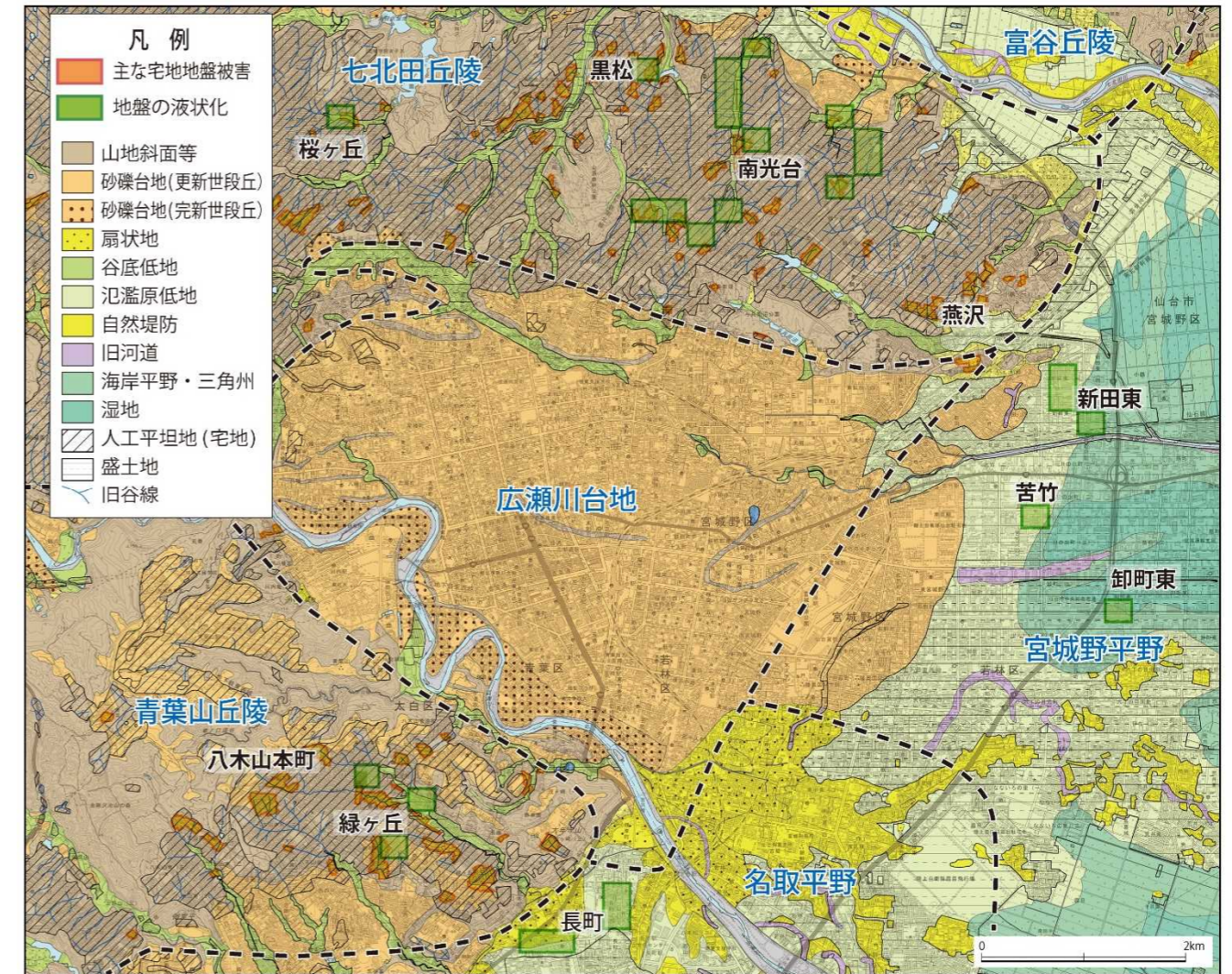
図2. 2011年東北地方太平洋沖地震の主な宅地地盤被害及び地盤の液状化分布図
