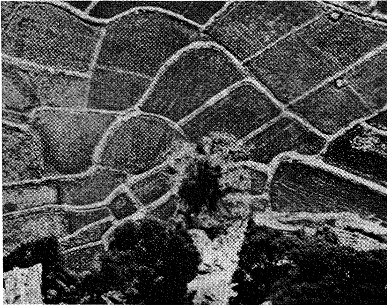
第3図 崩壊地（崩壊斜面）前面にある魚の鱗のような地割り、崩壊発生の都度一枚ずつ新しい地割りがつくられたあとである。（1970年12月セスナ機上より撮影、川崎逸郎）
