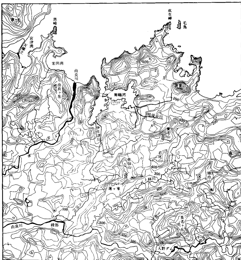
図-4 舞鶴図幅を中心とした丹波山地の切峯面図 谷幅1km以下の谷を埋積して作成。等高線は50m間隔である。
