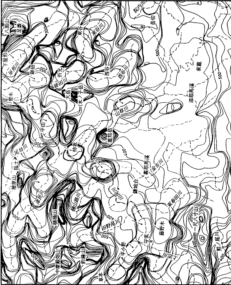
第1図 耶馬溪図幅の接峰図 (幅1 km以下の谷埋めによる。等高線間隔は20 m)
